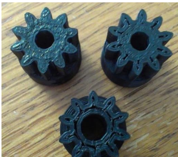
13-сурет. 3Д принтерде басылған тісті беріліс
